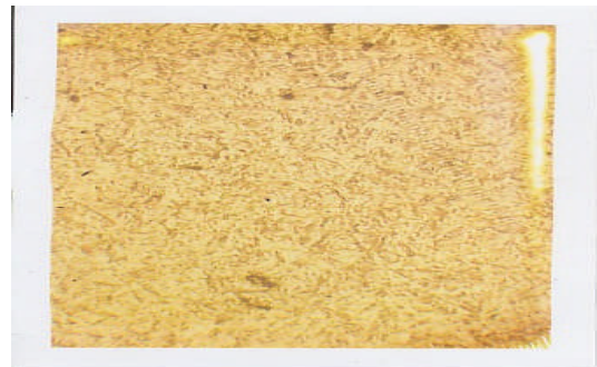
Gambar 6 : Benda uji pada suhu 800°C ditahan selama 15 menit, kemudian di quenching dengan air (Etsa 5 % Nital, Pembesaran 400 X)
