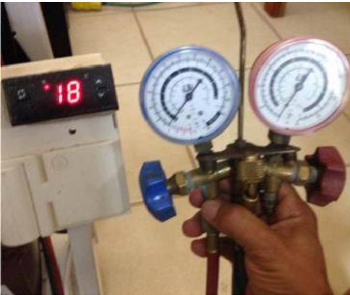
**Imagen 3. Manómetro para medir la presión**
