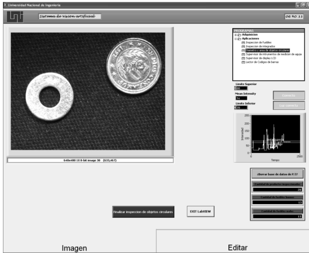
Fig. 5 Panel frontal para el Análisis de objetos circulares.
