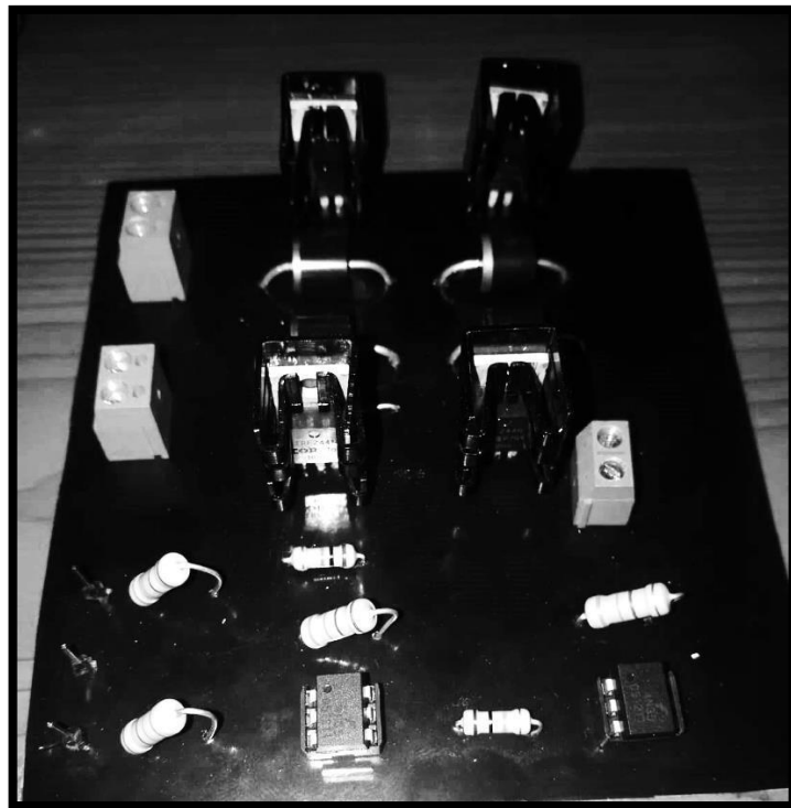
Fig.13 Circuito de control
