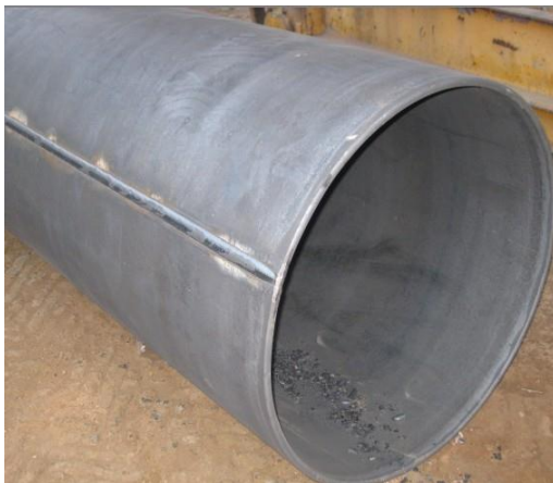
a) Longitudinal Welded Pipe
