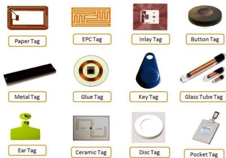
**Figura 4.** Tipos de tags RFID [21].
