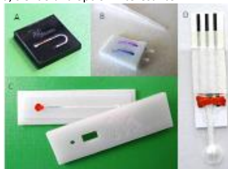
Figura 3. \mu TAD para el análisis de A) creatinina, B) potasio, C) glucosa en sangre total; D) electrodo serigrafiado precargado con un compuesto de rutenio para análisis electroquimioluminiscente.
