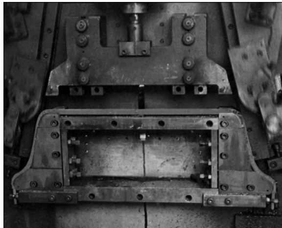
Fig. 3. Heavy bending tables for truck stabilizer bars Rys. 3. Ciężkie stoły do gięcia stabilizatorów do samochodów ciężarowych
