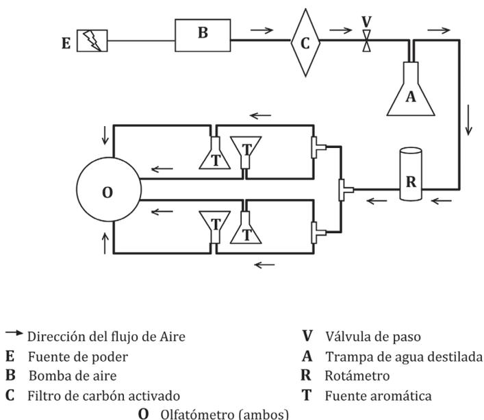
Fig. 2. Representación esquematizada de todos los componentes de ambos olfatómetros de 4 brazos modificados.
