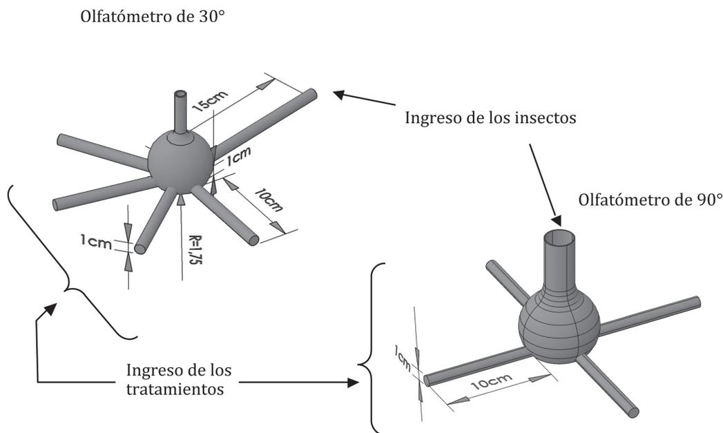
Fig. 1. Dos diseños innovadores de olfatómetros puestos a prueba con un atrayente de acción comprobada sobre *H. hampei*.
