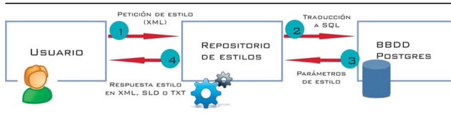
Figura 4. Ejemplo de comunicación entre el usuario, la base de datos Postgres y el Catálogo-Repository
