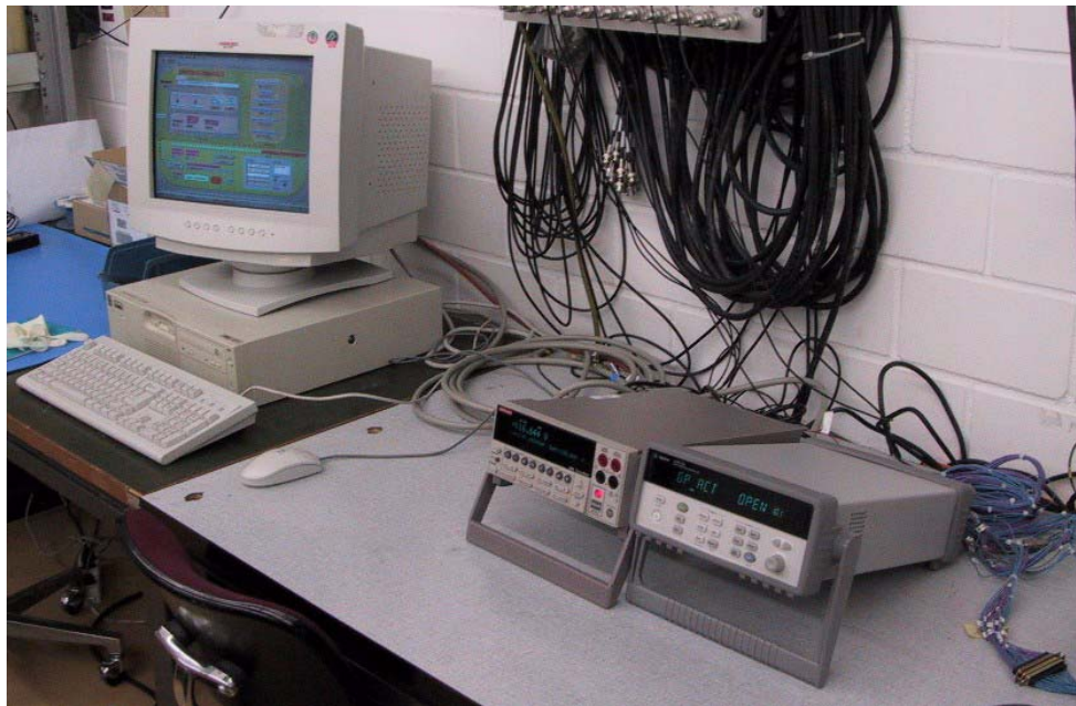
Figura 4.17 Il sistema di acquisizione dati (da sinistra verso destra): il PC con il software LabVIEW, il Keithley, e la Switch Unit Agilent.
