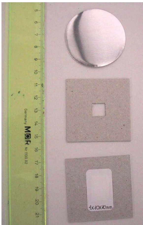
Figura 4.16 Preparazione fogli di alluminio per il calcolo del tempo di irraggiamento.
