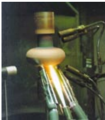
FIG. II.4 – Réalisation de revêtement par projection thermique
