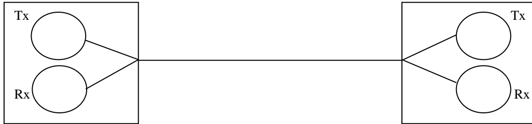
Figura 5.1: Collegamento tra i due PC con raffigurati i due processi di trasmissione e ricezione; si noti che la trasmissione è half-duplex dal momento che i processi sono sequenziali.
