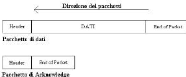
Figura 2.2: Protocollo DSLink a livello di pacchetto.
