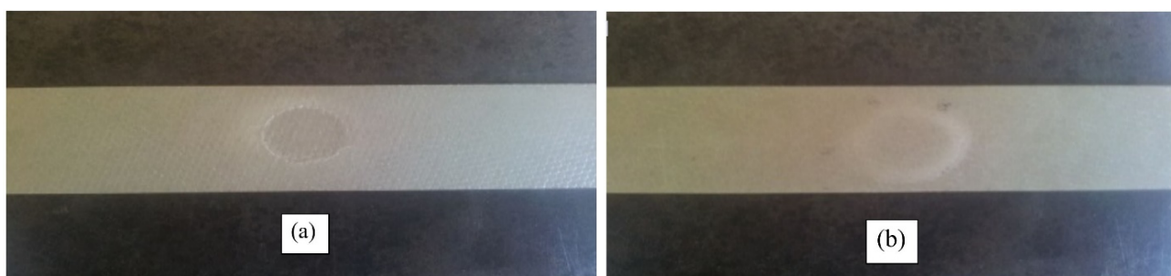
Fig. 23 - Zones d'endommagements, (a) surface supérieur (b) surface intérieure
