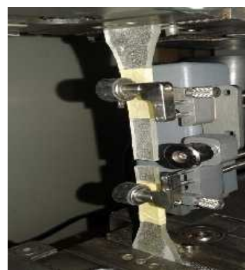
Fig. 5 - Essai de traction sur la machine Zwick
