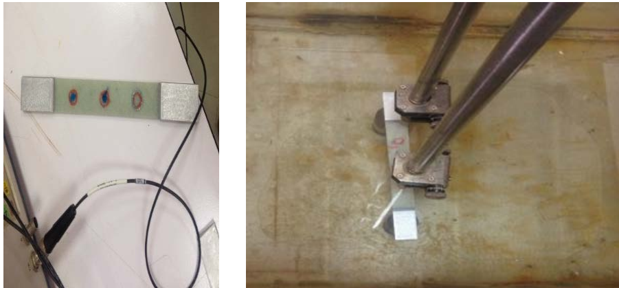
Fig. 16 - Éprouvette en Banc d'essai ultrason
