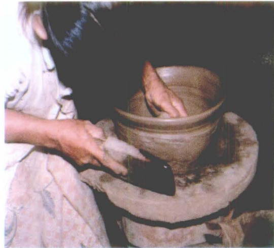
Pembuatan gerabah dengan teknik tatap pelandas dan roda putar lambat.
