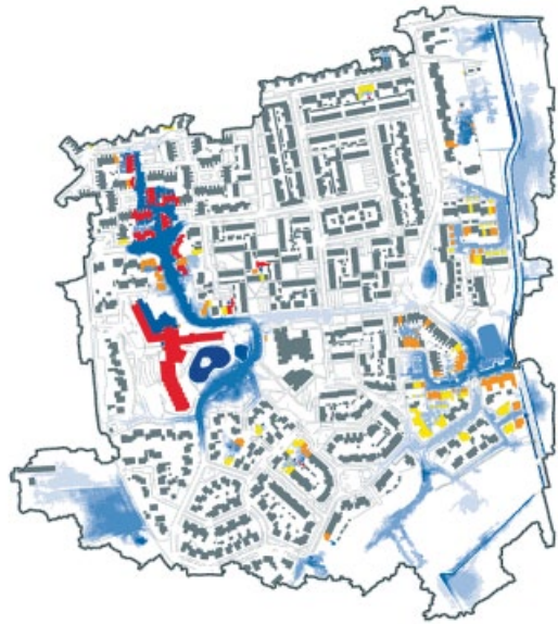
Figuur 2.2 Visualisatie 2D-berekening situatie vóór aanleg bergingsvoorzieningen.
