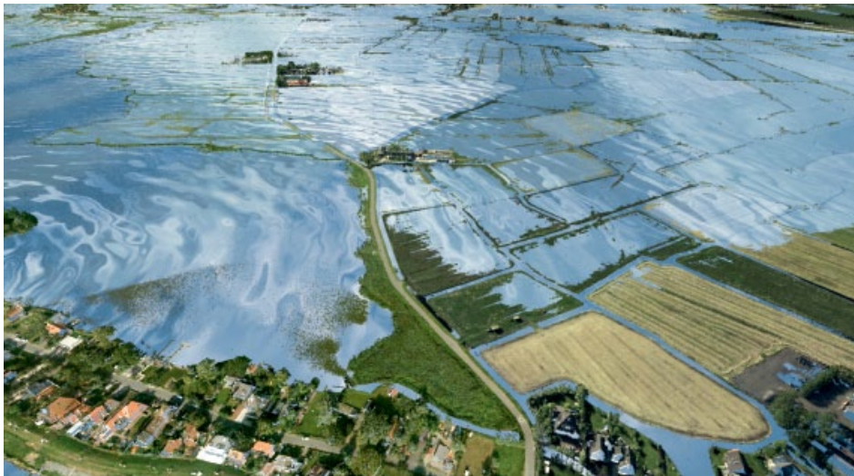
Figuur 19.4 Visualisatie 2D overstromingsberekening met 3Di voor Waterland (ruimtelijke resolutie van 0,5x0,5 m)
