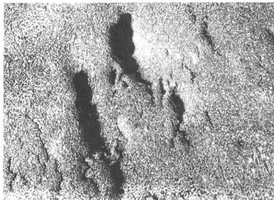
Figura 11. Grietas típicas de la zona fundida en aceros inoxidables 347, 4% deformación aplicada 100X, M.O.
