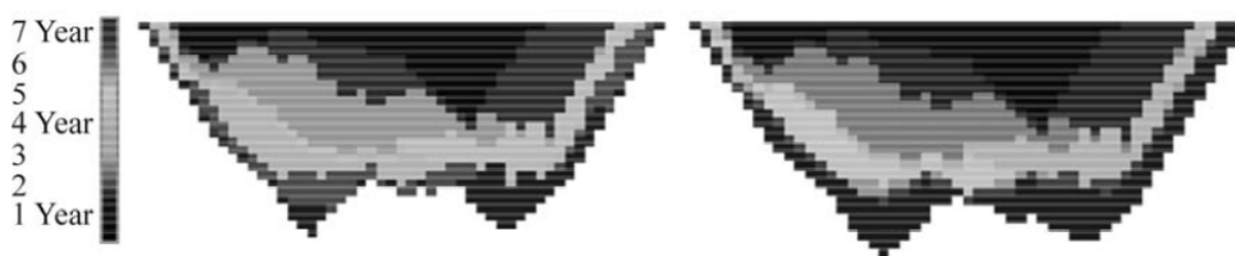
Figure 2-1 Les contours stochastiques de fosses sont plus larges que ceux obtenus par les méthodes conventionnelles (Dimitrakopoulos 2011)
