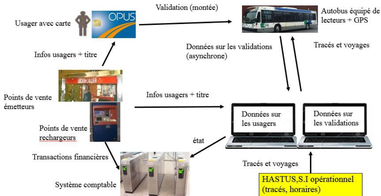
Figure 2-1: Diagramme fonctionnel du paiement par cartes à puce de STO (M. Trépanier et al., 2004)
