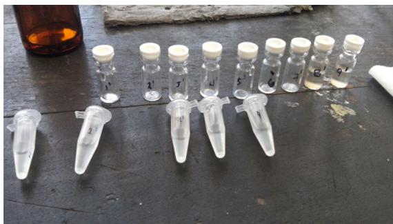
Figura 2.11: Muestras preparadas para la inyección en el cromatógrafo de gases.
