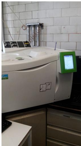
Figura 2.10: Cromatógrafo de Gases Clarus 580, U.A.M.-Iztapalapa.
