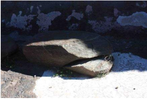
Fig. 5.53. Roca con fractura debido a la torrefacción del material.
