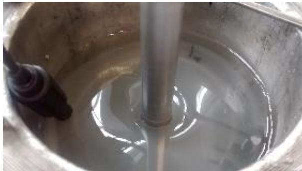
Figura 4-8. Vórtice generado por el NR-3.0 a Re= 128 .
