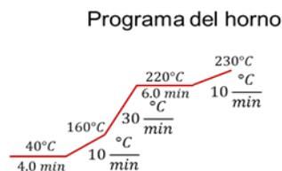
**Figura B. 3** Método cromatográfico empleado para la cuantificación de especies en fase líquida de la PCD de glicerol.
