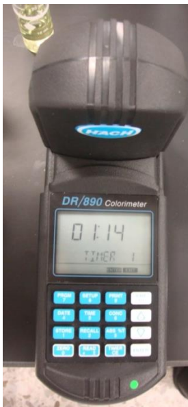
Figura 4-16. Reacción química durante la determinación de sílice. Antes de cumplirse 10 minutos de reacción se formó el complejo de sílice principalmente. La imagen muestra el tiempo restante para la reacción y la celda en color amarillo arriba a la izquierda.
