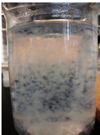
Figura 4-13. Muestra de agua con un precipitado de hidróxido de magnesio e hidróxido de aluminio. Se coadyuva a la separación con un floculante orgánico para una mayor velocidad de sedimentación.
