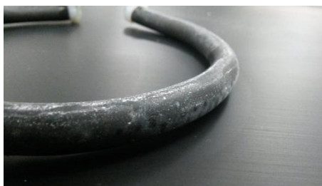
Figura 6-7. Película de hidróxidos y carbonatos formada en la superficie en el difusor de aire.
