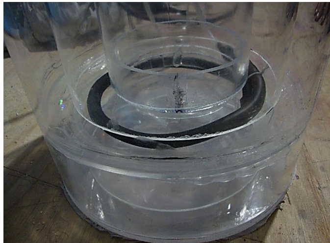
Figura 4-5. Colocación del difusor de aire en el fondo del reactor, se aprecia el espacio entre los tubos de arrastre. La conexión con las dos líneas de aire se realizó posteriormente.
