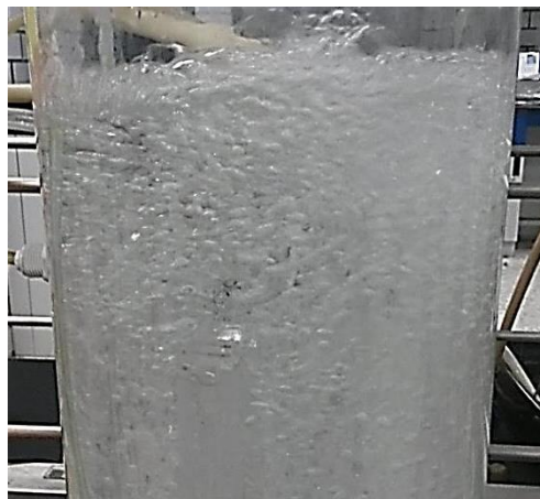
Figura 6-2. El exceso de aire suministrado incrementó la coalescencia de burbujas en la zona ascendente.
