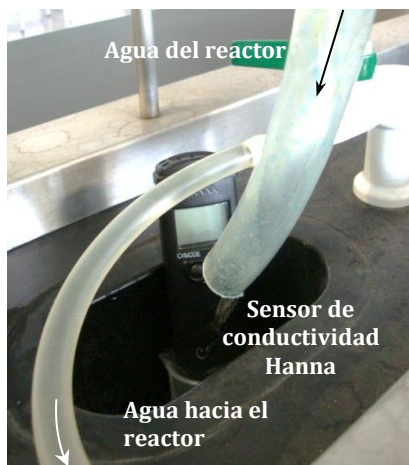
Figura 4-12. Colocación del recipiente colector de agua a la salida del reactor airlift con el sensor de conductividad Hanna. Se aprecia también la válvula de agua de alimentación al reactor.
