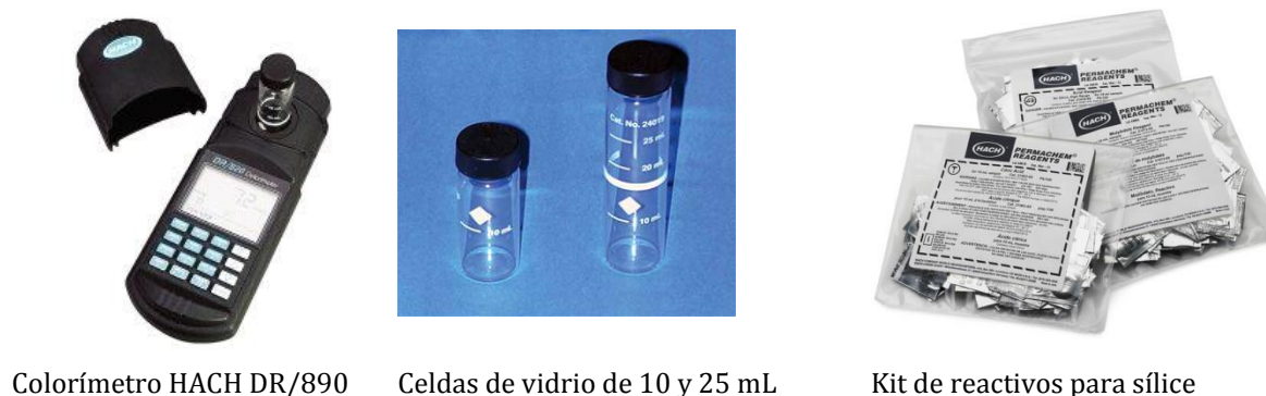
Figura 4-14. Principales componentes del equipo para medición de sílice por colorimetría.
