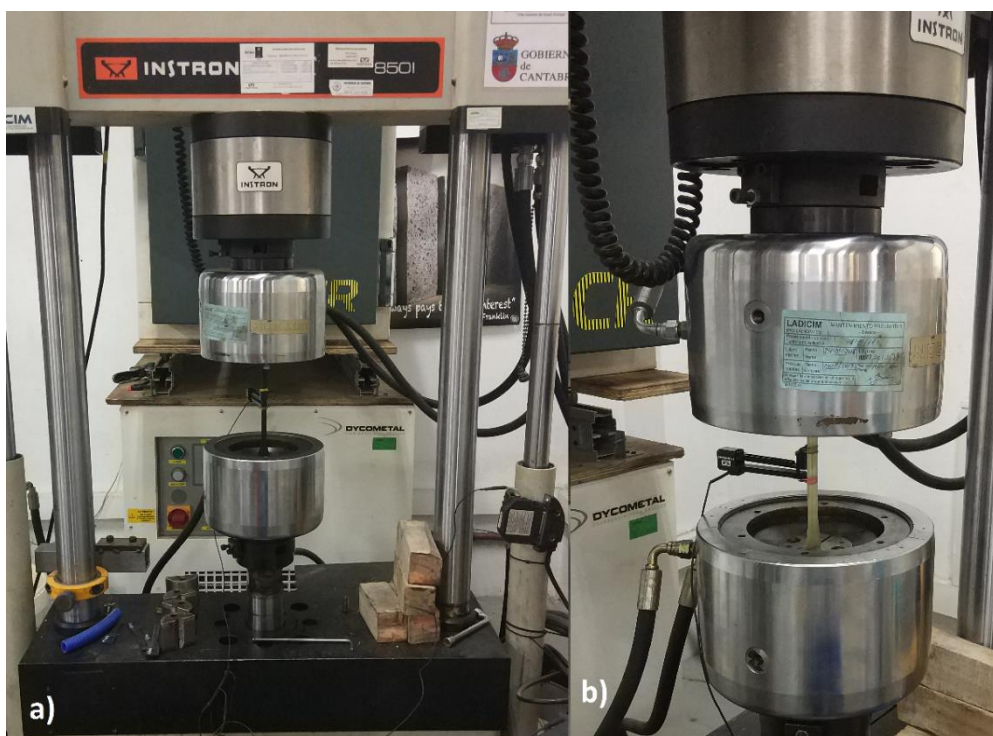
Figura 3.13: Montaje ensayos de tracción: a) General; b) Colocación del extensómetro
