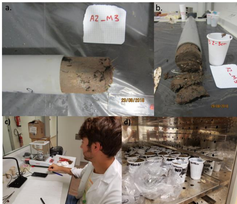
Figura 6. Procesado de testigos: a) extracción del sedimento por la parte superficial b) seccionado del sedimento; c) pesada de cada sección y d) secado.
