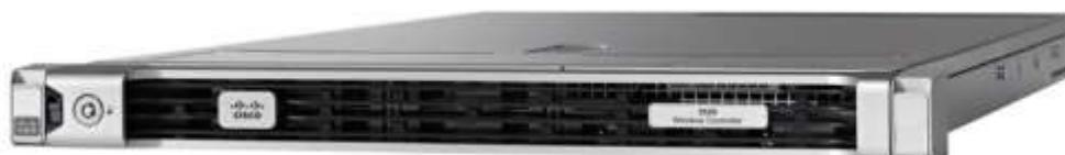
Figura 45: Controladora de red disponible en el aeropuerto Cisco 5520 Wireless Controller
