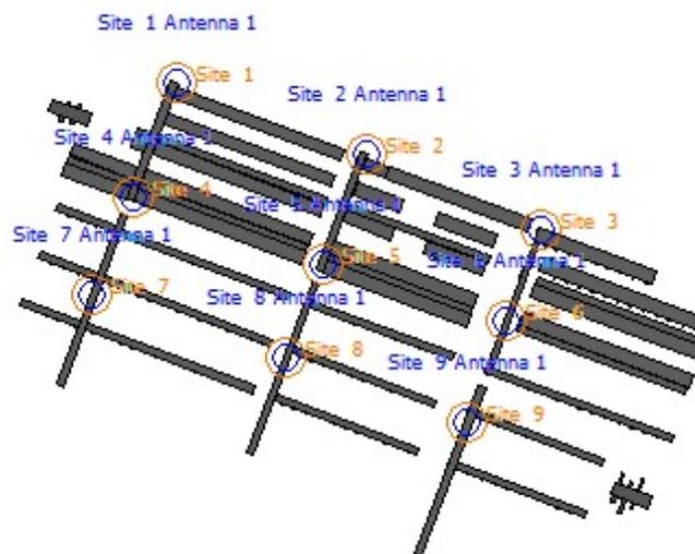
Figura 28: Posicionamiento de nueve puntos de acceso en el parking del aeropuerto
