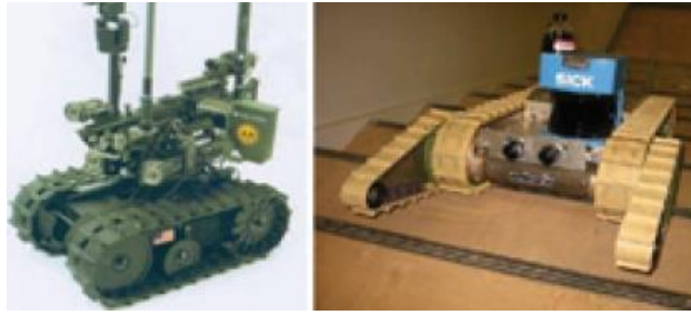
Figura 4.5. Locomoción por orugas (Barrientos Sotelo, et al., 2007).
