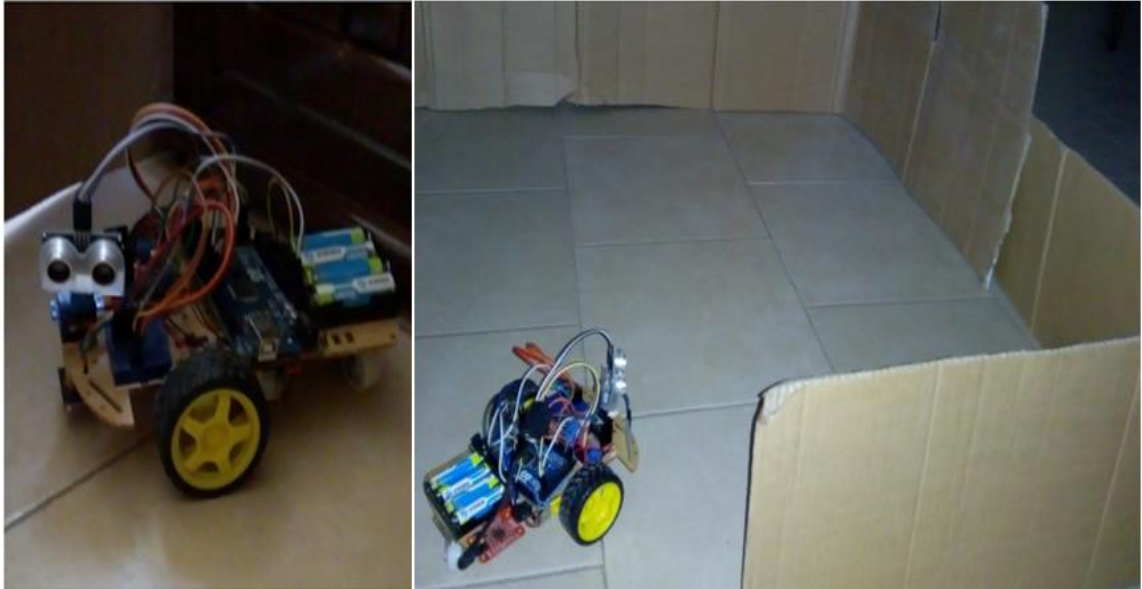
Figura 6.12. Funcionamiento inicial del robot móvil: Desplazamiento y evasión de obstáculos.
