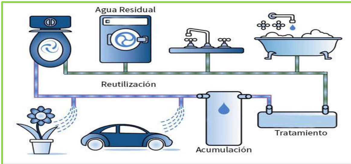
Figura 3. Proceso de reúso de aguas grises. (Hídrica, 2016)
