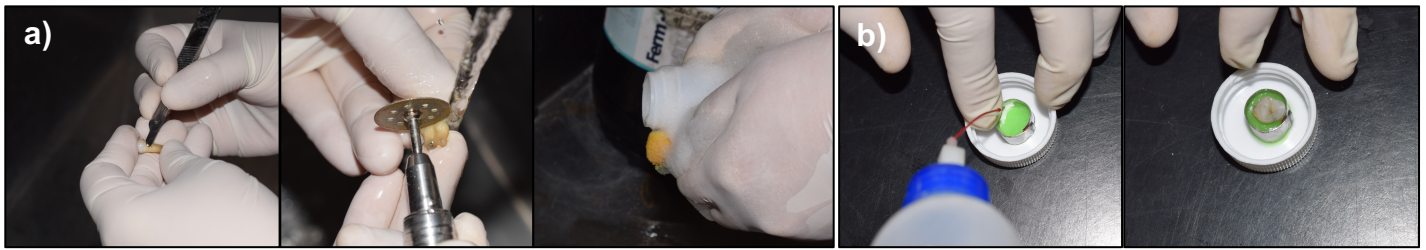
Figura 2. a) Eliminación de tejido del diente, b) Montaje del diente en acrílico.
