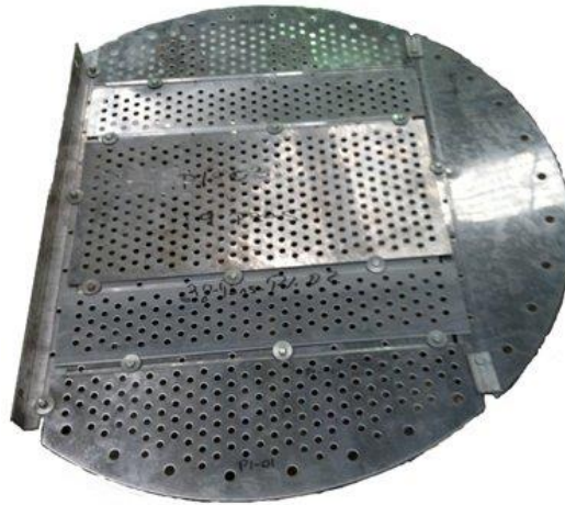
Figura 6-14: Platos perforados - Fuente: Maguarvi
