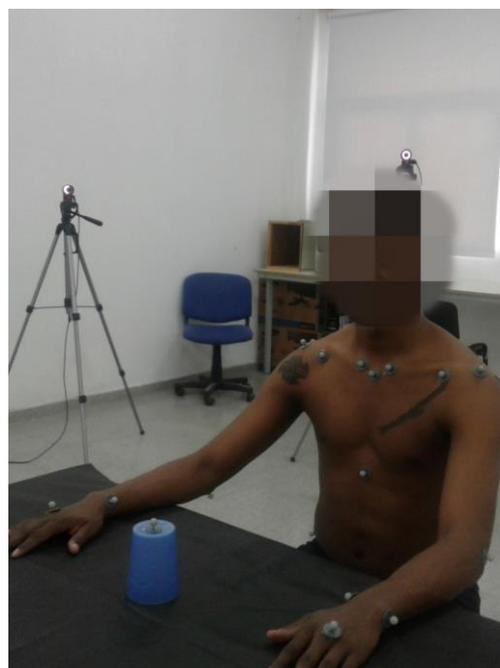
Figura 2. Protocolo de marcadores utilizado durante los registros del movimiento de alcanzar y agarrar.
