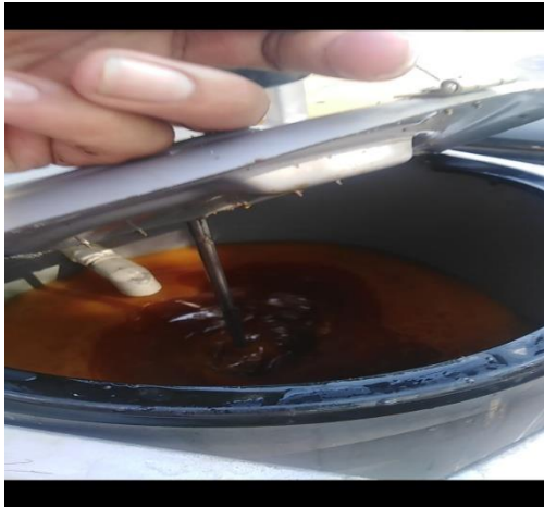
Figura 21: Agitación de lavado de biodiesel
