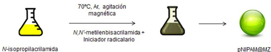
Figura 13. Proceso de obtención de NPs macizas de pNIPAM.
