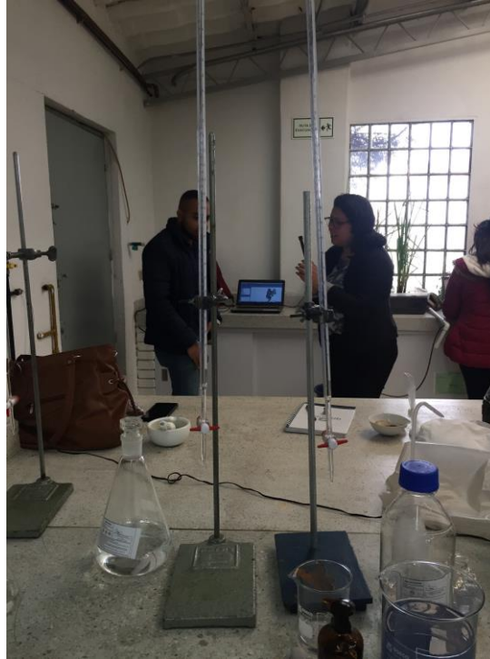
Imagen 6-1. Montaje para determinar la alcalinidad
