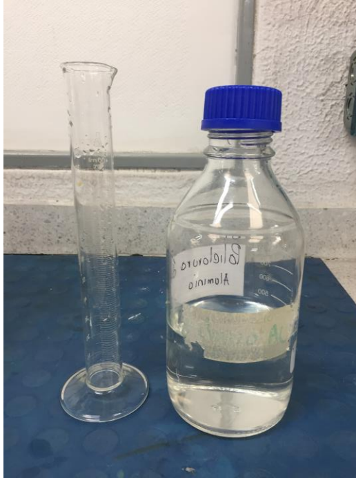
Imagen 6-5. Coagulante de policloruro de aluminio y probeta para medición
