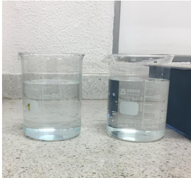
Imagen 6-7. Muestra de agua contaminada después de proceso de coagulación
