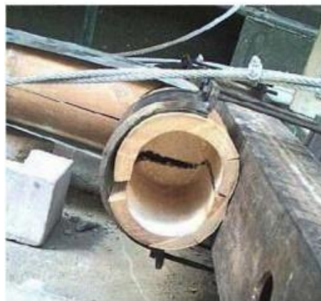
Figura 12 Falla de un elemento de bambú por compresión perpendicular a la fibra.
