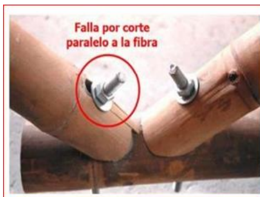
Figura 13 Falla por corte paralelo a la fibra.
