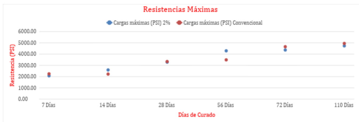
Figura 6. Comportamiento de las muestras adicionadas con 2% de ceniza volante vs días de curado
