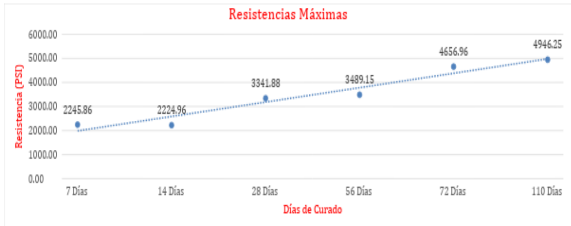
Figura 5. Comportamiento de las muestras convencionales sin adición de ceniza volante vs días de curado
