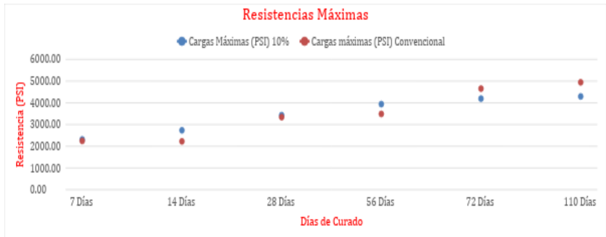
Figura 10. Comportamiento de las muestras adicionadas con 10% de ceniza volante vs días de curado
