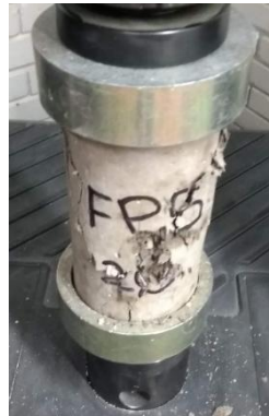
Figura 44. Cilindro de concreto reforzado con fibra de PET. FP5 después de ensayo a compresión.
