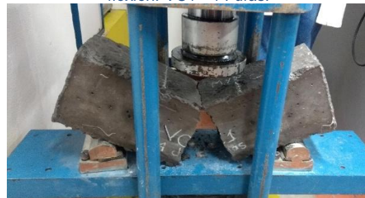
Figura 30. Viga de concreto convencional después de ensayo a flexión. VC1 - 14 días.
