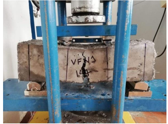
Figura 54. Viga de concreto reforzado con fibras de vidrio. VFV1 - 14 días
