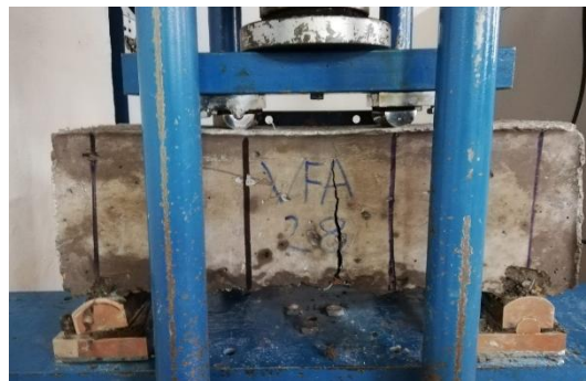
Figura 39. Viga de concreto reforzada con fibras de acero después de ensayo a flexión. VA2 - 28 días.
