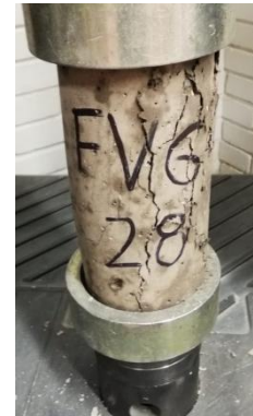
Figura 53. Cilindro de concreto reforzado con fibra de vidrio FV6 después de ensayo a compresión.
