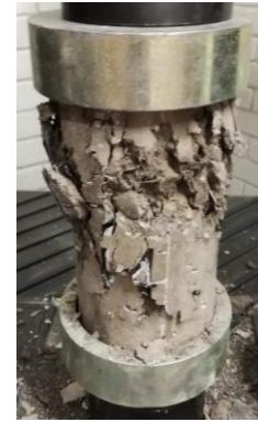
Figura 35. Cilindro de concreto reforzado con fibras de acero después de ensayo a compresión. FA4
