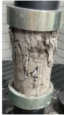
Figura 34. Cilindro de concreto reforzado con fibras de acero después de ensayo a compresión. FA3
