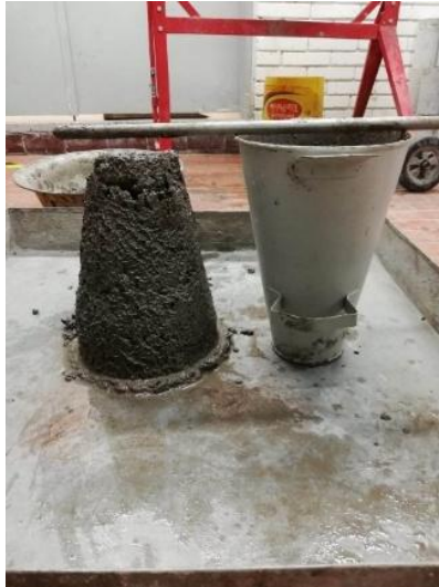
Figura 1. Prueba del cono de Abrams para concreto convencional.
