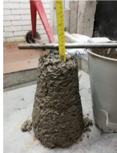
Figura 2. Prueba del cono de Abrams para concreto reforzado con fibras de PET.
