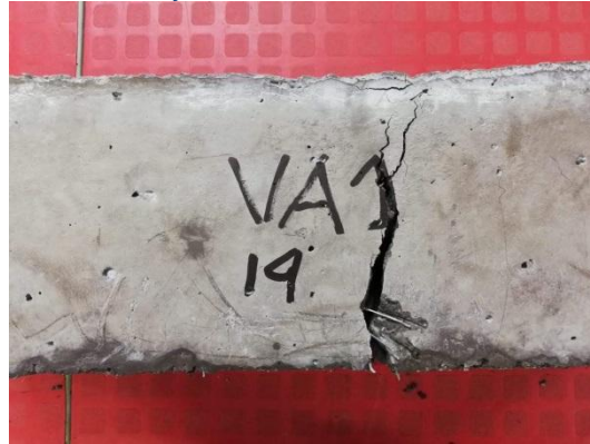
Figura 38. Viga de concreto reforzada con fibras de acero después de ensayo a flexión. VA1 - 14 días.
