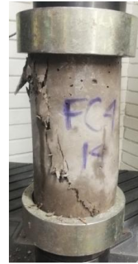
Figura 59. Cilindro de concreto reforzado con fibras de cáñamo FC4 después de ensayo a compresión.
