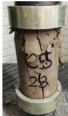
Figura 28. Cilindro de concreto convencional C5 después de ensayo a compresión.
