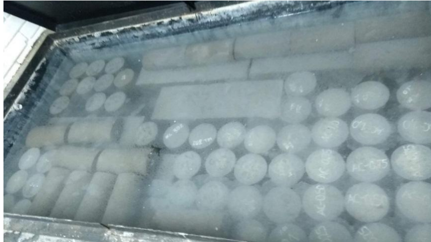
Figura 23. Muestras de concreto sumergidas en tanque para curado.
