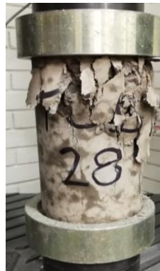
Figura 60. Cilindro de concreto reforzado con fibras de cáñamo FC5 después de ensayo a compresión.
