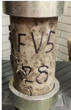
Figura 52. Cilindro de concreto reforzado con fibras de vidrio FV5 después de ensayo a compresión.
