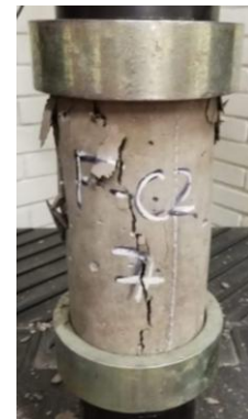
Figura 57. Cilindro de concreto reforzado con fibras de cáñamo FC2 después de ensayo a compresión.
