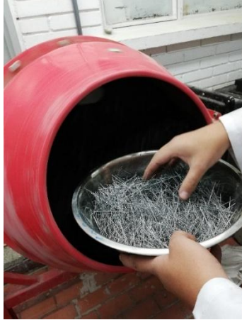
Figura 5. Adición de fibras de PET en la mezcla de concreto.
