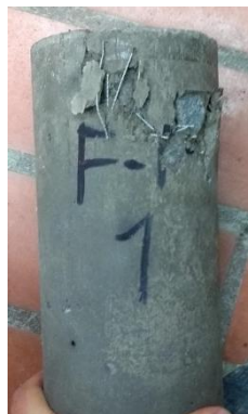
Figura 40. Cilindro de concreto reforzado con fibras de PET. FP1 después de ensayo a compresión.
