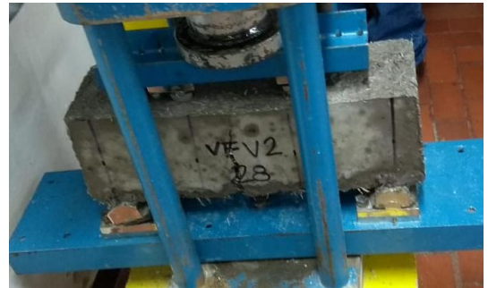
Figura 55. Viga de concreto reforzado con fibras de vidrio. VFV2 - 28 días
