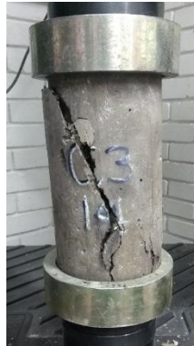
Figura 26. Cilindro de concreto convencional C3 después de ensayo a compresión.
