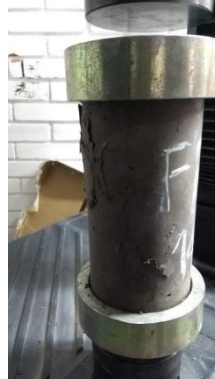
Figura 42. Cilindro de concreto reforzado con fibra de PET. FP3 después de ensayo a compresión.
