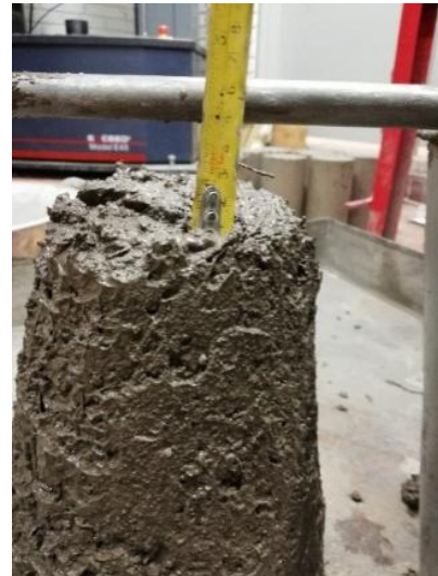
Figura 4. Prueba del cono de Abrams para concreto reforzado con fibras de cáñamo.
