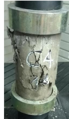
Figura 27. Cilindro de concreto convencional C4 después de ensayo a compresión.
