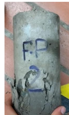
Figura 41. Cilindro de concreto reforzado con fibras de PET. FP2 después de ensayo a compresión.
