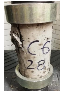
Figura 61. Cilindro de concreto reforzado con fibras de cáñamo FC6 después de ensayo a compresión.
