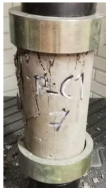
Figura 56. Cilindro de concreto reforzado con fibras de cáñamo FC1 después de ensayo a compresión.
