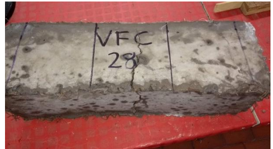
Figura 63. Viga de concreto reforzado con fibras de cáñamo después de ensayo a flexión. VFC2 - 28 días.
