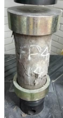
Figura 43. Cilindro de concreto reforzado con fibra de PET. FP4 después de ensayo a compresión.
