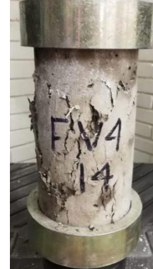
Figura 51. Cilindro de concreto reforzado con fibras de vidrio FV4 después de ensayo a compresión.
