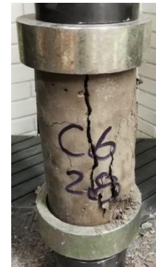
Figura 29. Cilindro de concreto convencional C6 después de ensayo a compresión.
