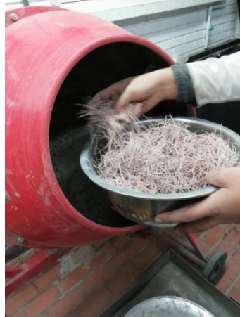
Figura 6. Adición de fibras de vidrio en la mezcla de concreto.
