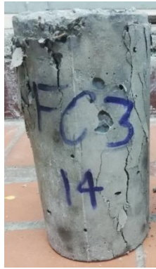
Figura 58. Cilindro de concreto reforzado con fibras de cáñamo FC3 después de ensayo a compresión.
