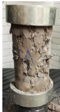
Figura 36. Cilindro de concreto reforzado con fibras de acero después de ensayo a compresión. FA5
