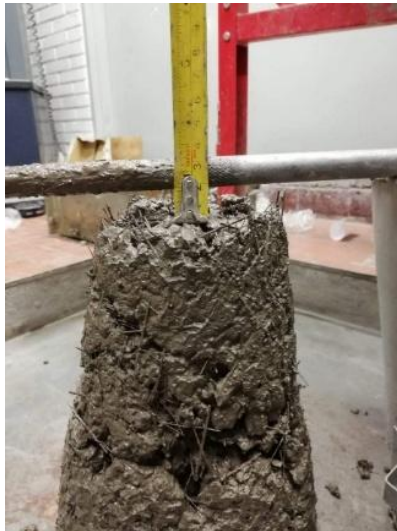
Figura 3. Prueba del cono de Abrams para concreto reforzado con fibras de vidrio.
