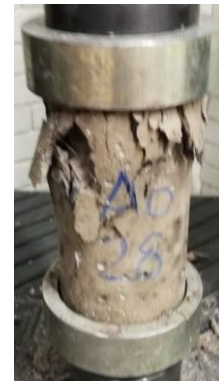
Figura 37. Cilindro de concreto reforzado con fibras de acero después de ensayo a compresión. FA6
