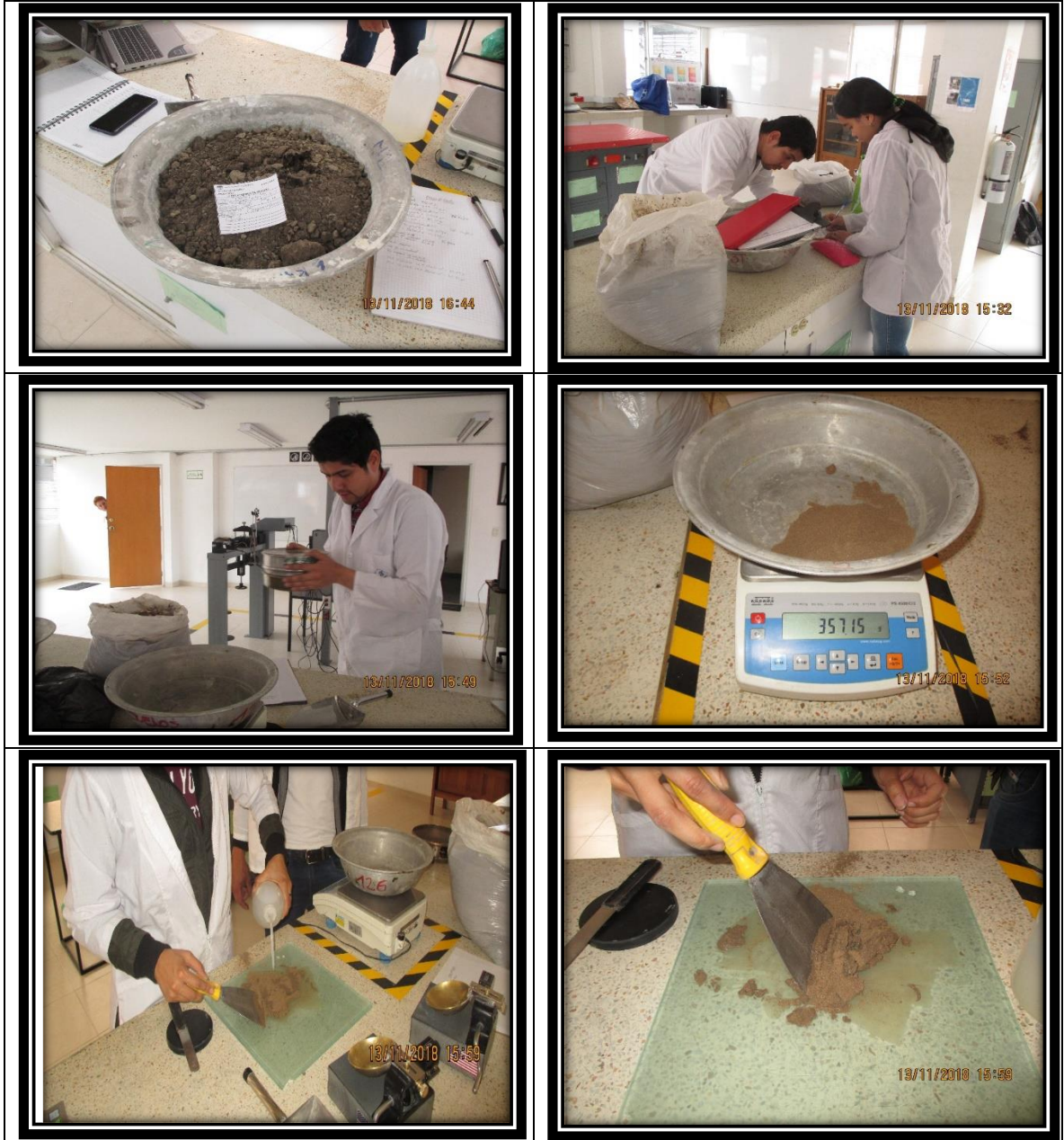
Imagen 32. Registro fotográfico del Límite líquido y plástico
