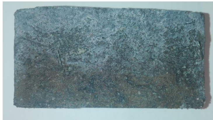
.Figura 12. Penetración de cloruros en muestra analizada.
