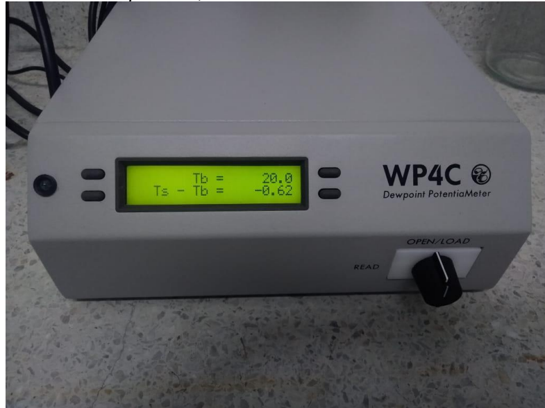
Figura 52. Diferencia de temperatura, Muestra: 80% Caolín + 20% Diatomeas + 0% Humedad
