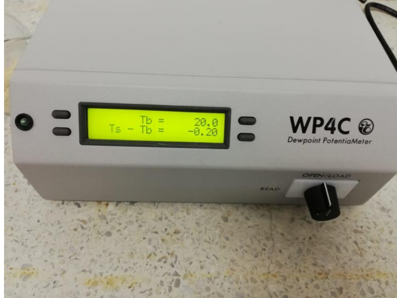
Figura 42. Diferencia de temperatura, Muestra: 90% Caolín + 10% Diatomeas + 0% Humedad
