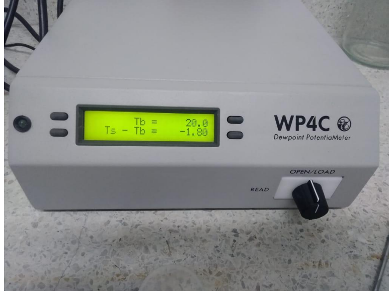
Figura 56. Diferencia de temperatura, Muestra: 80% Caolín + 20% Diatomeas + 2% Humedad
