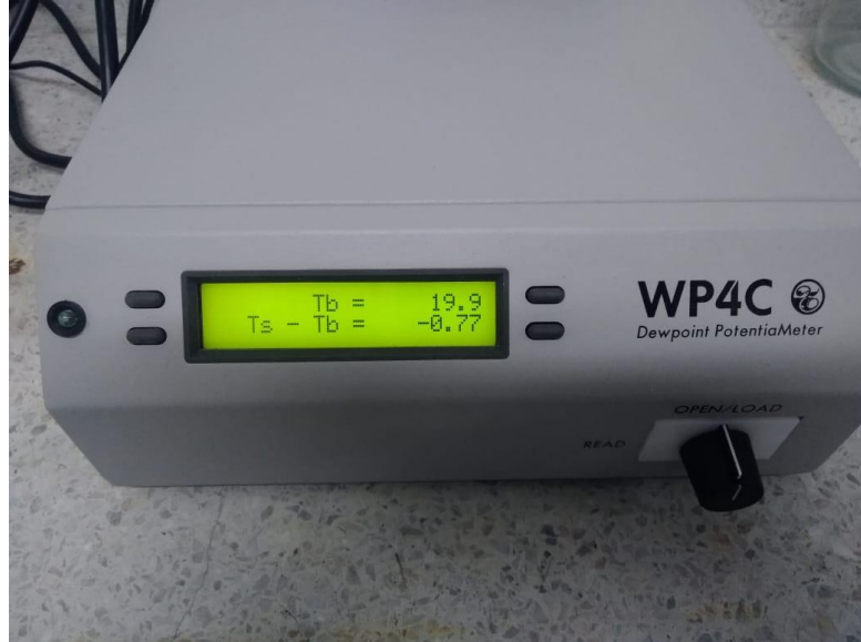
Figura 58. Diferencia de temperatura, Muestra: 80% Caolín + 20% Diatomeas + 3% Humedad
