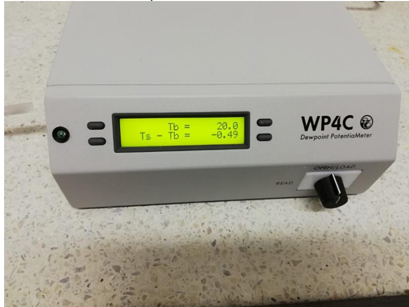
Figura 24. Diferencia de temperatura, Muestra: 100% Caolín + 1% Humedad
