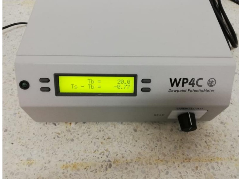
Figura 50. Diferencia de temperatura, Muestra: 90% Caolín + 10% Diatomeas + 4% Humedad
