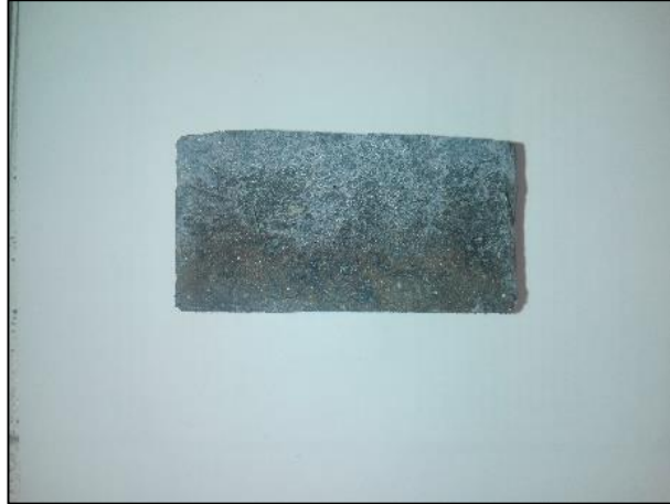
Ilustración 21 Muestra cortada axialmente cubierta con nitrato de plata
