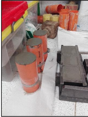
Ilustración 12 Muestra para ensayo de resistencia a la compresión
