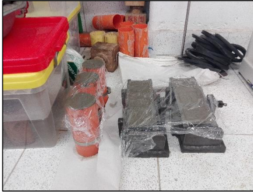
Ilustración 12 Muestra para ensayo de resistencia a la compresión
