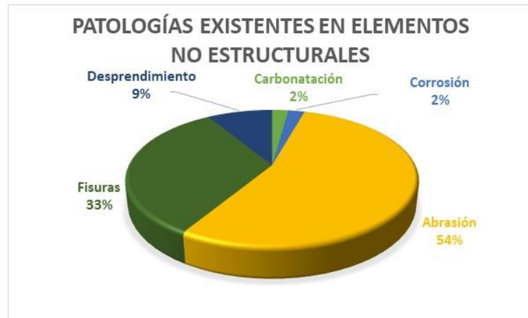
Gráfico 19. Porcentaje de Patologías en Elementos No Estructurales Puente Eje 4
