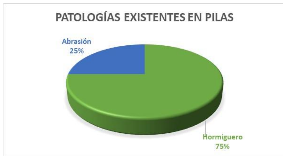
Gráfico 12. Porcentaje de Patologías en Pilas Puesto Eje 3
