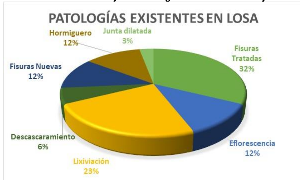
Gráfico 9. Porcentaje de Patologías en Losa Puesto Eje 2
