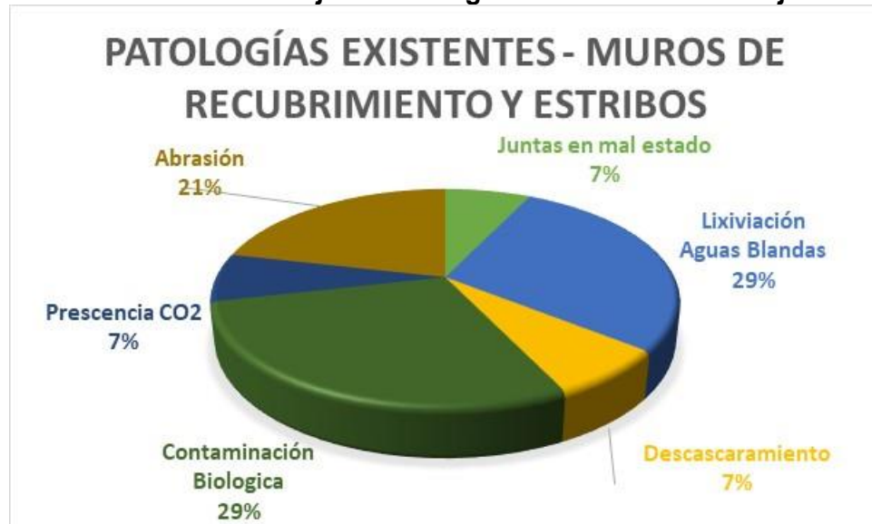
Gráfico 6. Porcentaje de Patologías en Estribo Puesto Eje 2
