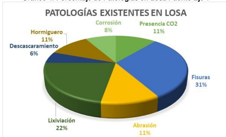
Gráfico 4. Porcentaje de Patologías en Losa Puesto Eje 1
