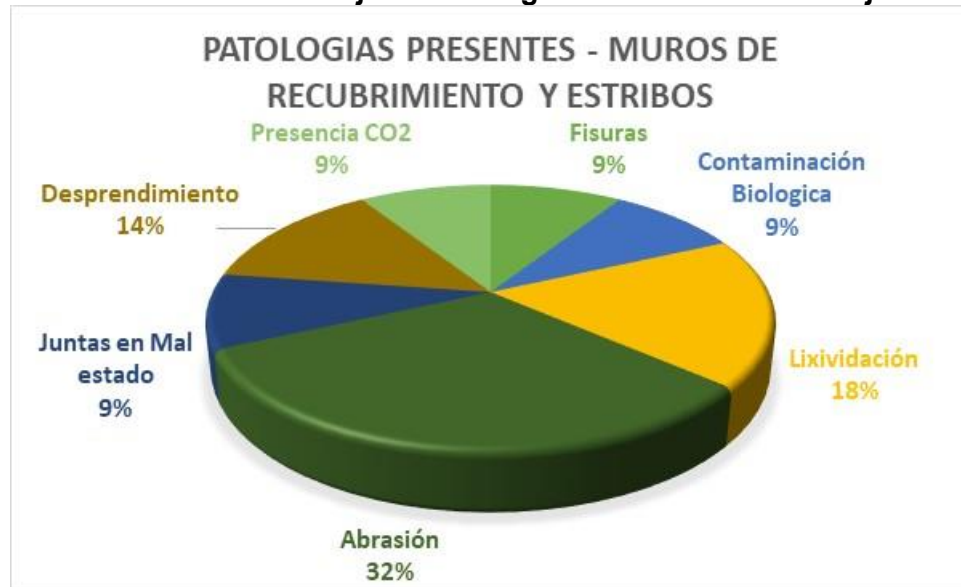
Gráfico 15. Porcentaje de Patologías en Estribo Puente Eje 4
