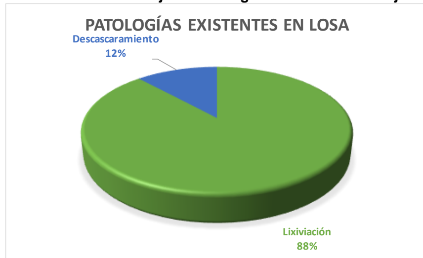
Gráfico 13. Porcentaje de Patologías en Losa Puesto Eje 3
