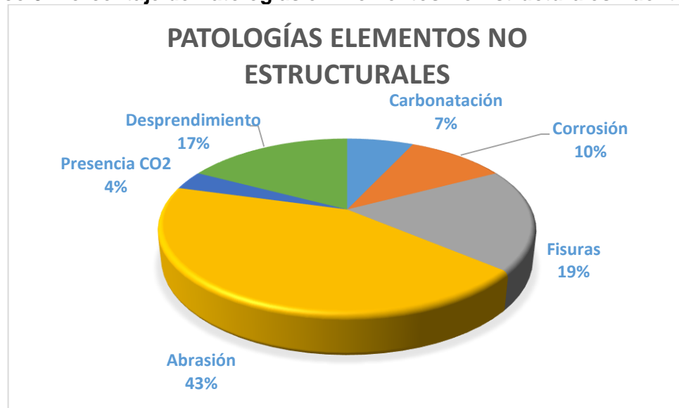
Gráfico 5. Porcentaje de Patologías en Elementos No Estructurales Puente Eje 1
