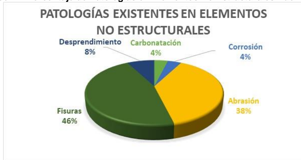
Gráfico 14. Porcentaje de Patologías en Elementos No Estructurales Puesto Eje 3
