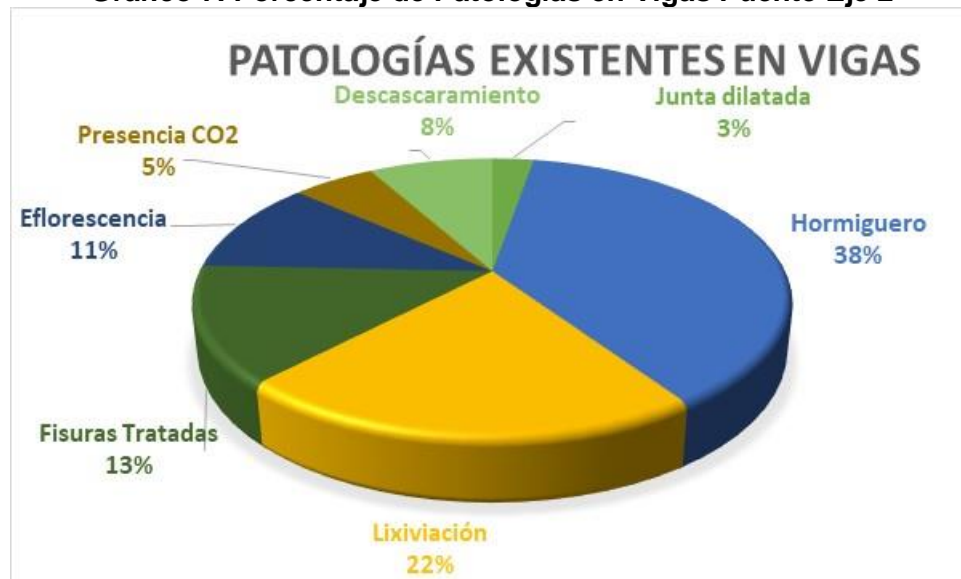
Gráfico 7. Porcentaje de Patologías en Vigas Puesto Eje 2
