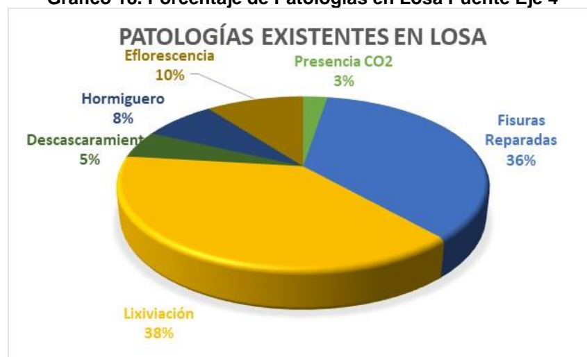
Gráfico 18. Porcentaje de Patologías en Losa Punte Eje 4
