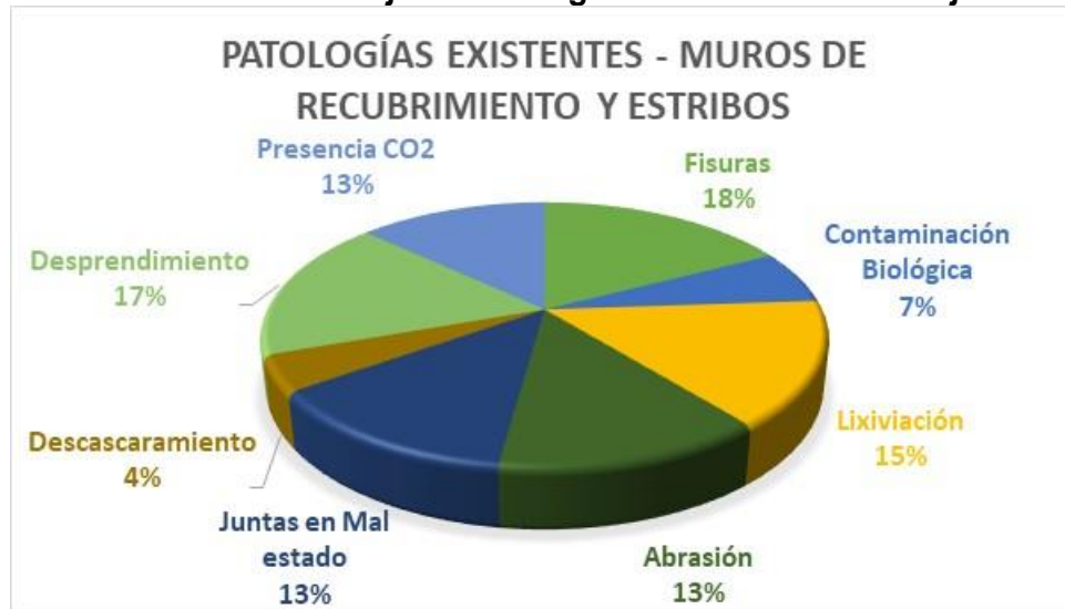
Gráfico 1. Porcentaje de Patologías en Estribo Puente Eje 1
