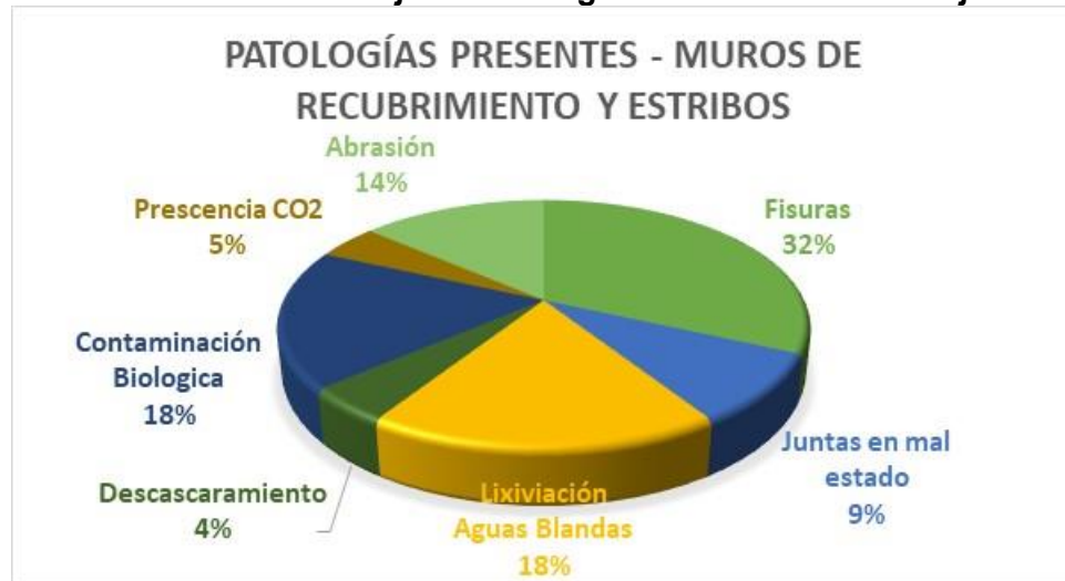
Gráfico 10. Porcentaje de Patologías en Estribo Puente Eje 3
