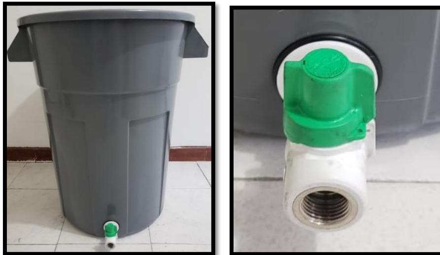
Figura 20. Tanque Salida de Agua Residual.
