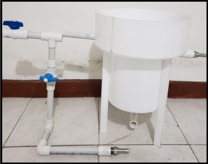
Figura 25. Construcción Estructura Sedimentador.
