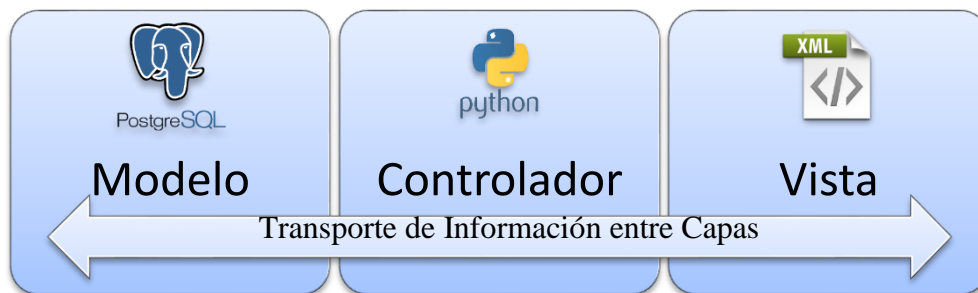
Figura 2.5. Relación Tecnologías utilizadas en Odoo con MVC. Representación básica del MVC con respecto a la tecnología que utiliza Odoo en su versión 10. Fuente: Elaboración propia.
