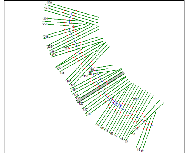
Figura 42. Vista en planta de las secciones transversales de la quebrada El Molino. Fuente: Obtenido del programa computacional HEC-RAS 5.0.5
