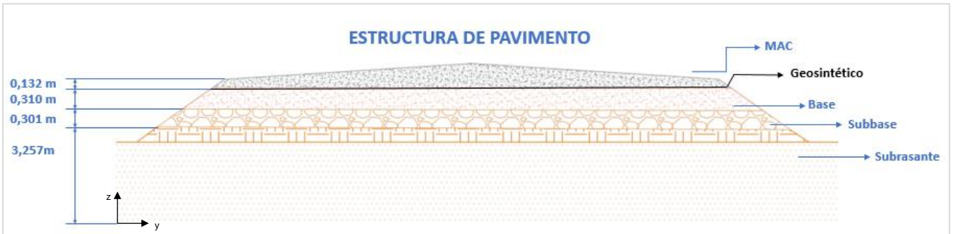
Figura 39. Diagrama de la estructura utilizada en los modelos con geosintético
