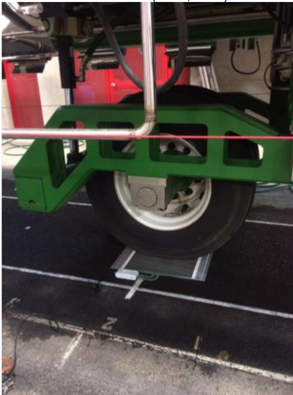
Figura 21. Sensor de presión bajo el neumático del HVS (Clark, 2016)
