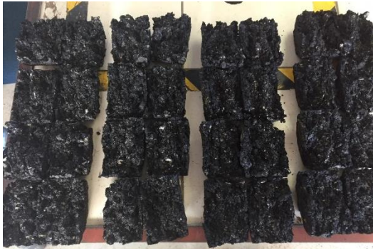
Figura 15. Pastillas luego de la falla de flujo y estabilidad Marshall.
