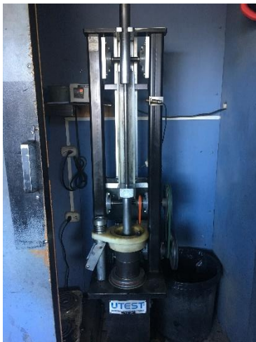
Figura 12. Método de compactación Marshall.
