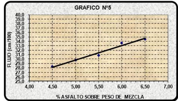
Figura 56. Gráfico 41. Valores correspondientes al flujo, según el contenido de asfalto.
