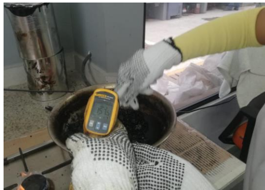
Figura 11. Verificación de la temperatura de mezclado.
