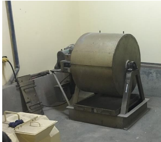
Figura 9. Máquina Los Ángeles utilizada en la prueba de resistencia a la Abrasión.
