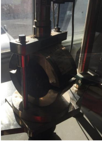
Figura 14. Prueba de laboratorio Marshall para determinar la estabilidad y flujo.
