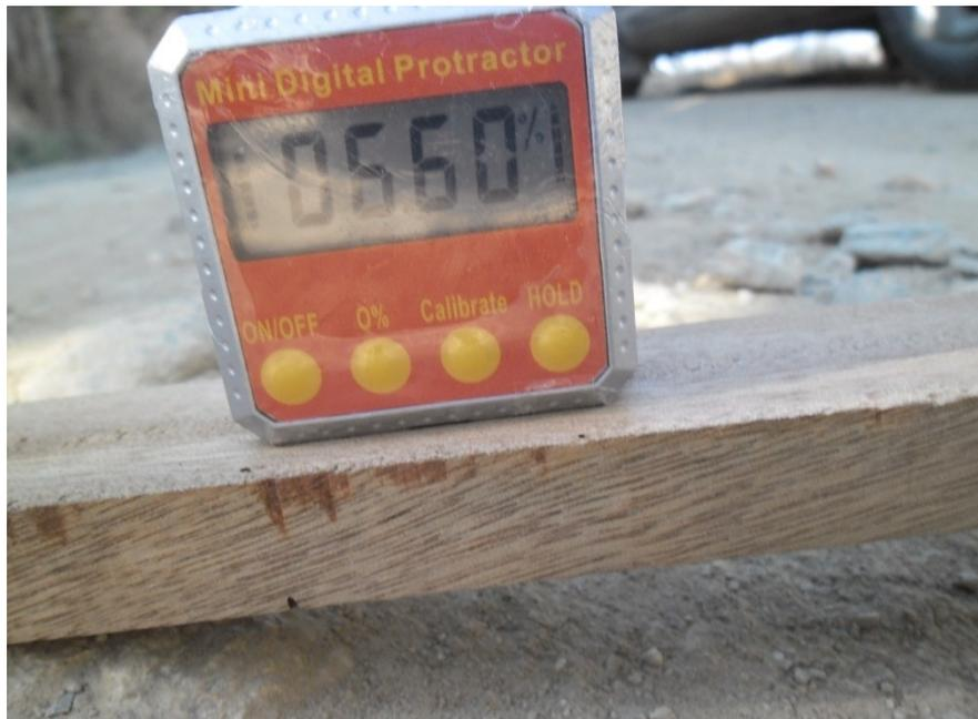
Valor obtenido de peralte con el inclinómetro digital
