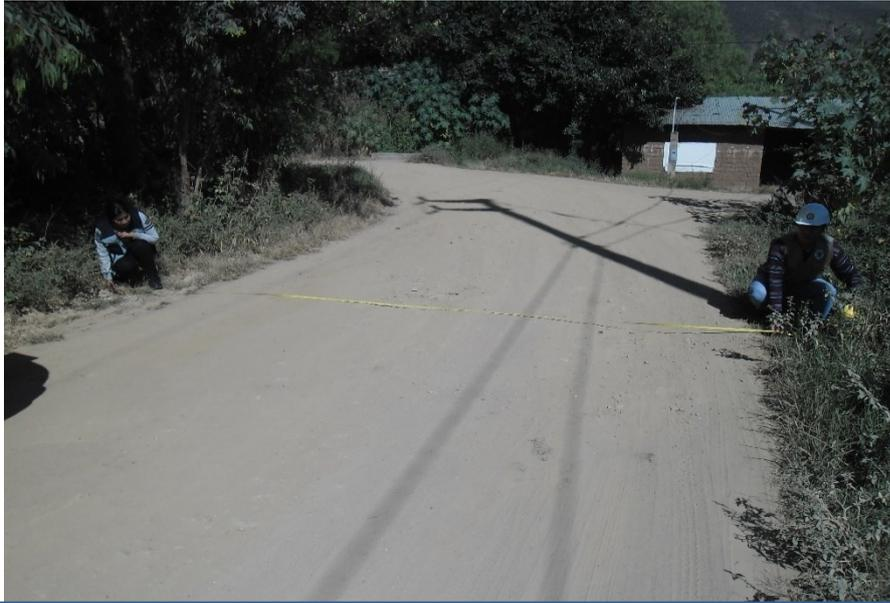
Medición del ancho de plataforma – tramo en tangente
